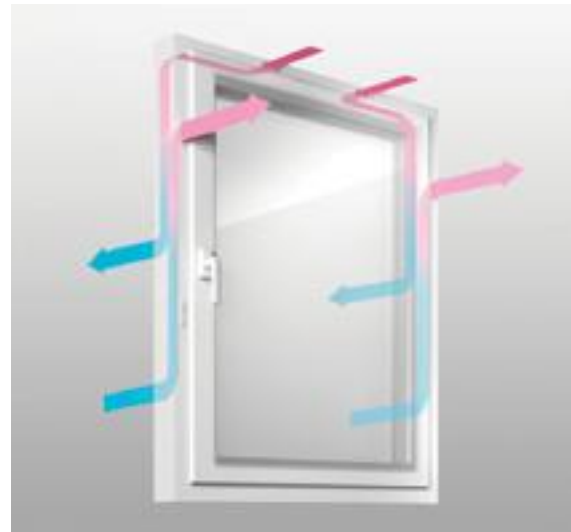
Рисунок 1. Оконная рама с управляемой системой вентиляции
